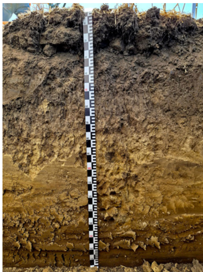
2. kép: Vastagabb humuszos „A” szint alatt felhalmozódási szint, majd a szelvény aljában agyagos víztartó réteg. Az „A” szint sajnos erősen hantos, a művelési mélység határozottan elkülönül a talaj érintetlen részétől.
