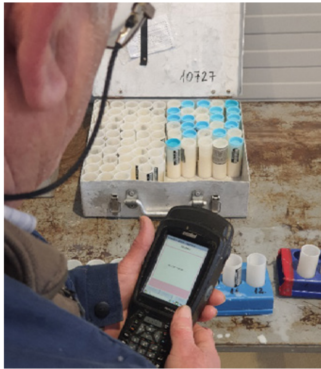
Manapság a termelésellenőr már kézi számítógéppel és abba beépített vonalkódolvasóval végzi a minták azonosítását és az adatok rögzítését. Tejvizsgálat az istállóban már nem zajlik. (Forrás: Kenéz Á.)
