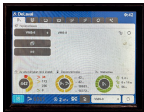
Helyszín: Agro-Lehel Kft. Jászberény, 2025. január – A V300 fejőrobot érintésképernyőjén a telepi mutatók, középen lent az aktuális fejési eredmények láthatóak.
