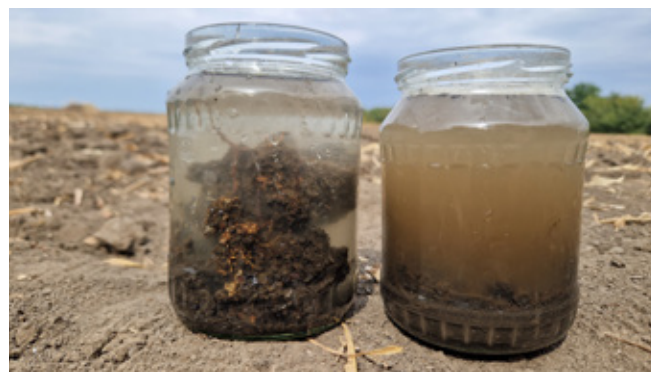
1. kép: Tartós és nem tartós szerkezeti elemek vizsgálata
