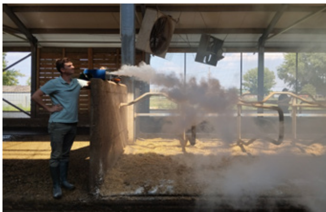
A légáramlás irányának, sebességének és a légcserének az ellenőrzése hidegfüst-képzővel a Dél-Alföldön (fotó: Orosz, 2024)
