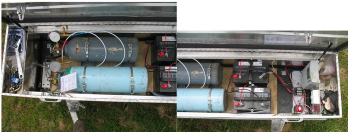
2. kép: Az 1. képen is látható szerszámosládában levő, nitrogén- és kalibráló gázokat (CH 4 -t és szén-dioxidot /CO 2 -t/) tartalmazó palackok a GreenFeed-rendszer megfelelő beállítására szolgálnak
