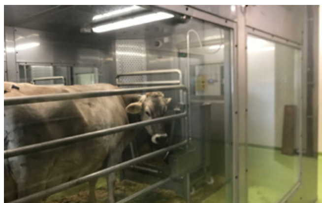
2. kép: A vizsgálat alatt a szarvasmarha mozgása korlátozott a légzőkamrában, Forrás: Niu (2022).
