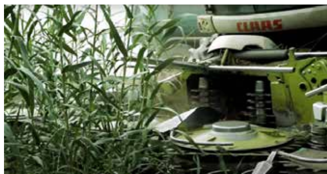
1. képsor: Claas Jaguar járvaszecskező sorfüggetlen kukoricaadapterrel
