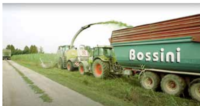
1. képsor: Claas Jaguar járvaszecskező sorfüggetlen kukoricaadapterrel
