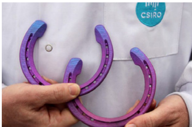
20. kép: 3D nyomtatott titánpatkók (forrás: www.newatlas.com )
