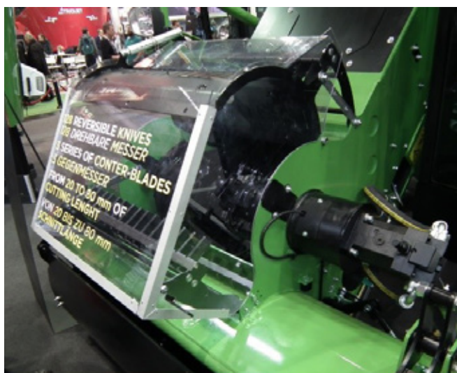
A Faresin önjáró mixerkocsin található 2-8 cm-es szeletméretet biztosító előaprító berendezés a silómáró fölött (Hannover, 2019., fotó: Rakóczki József)
