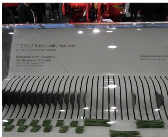
A bálázókon 17-26, de már az 50 kés is lehetséges. A kép a 3,6 cm-es szeletméretet mutatja be, ami növeli a bála súlyát, csökkenti a fajlagos költségeket, és könnyebbé teszi az etetést, mert nem kell előaprítás. (Hannover, 2019., fotó: Rakóczki József)
