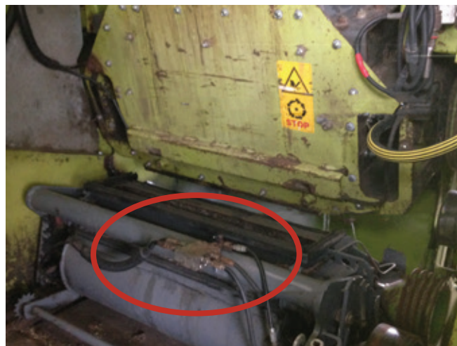
A sav adagolásának helye. Előnyösebb, ha belülről, a dob mögötti részbe, a kifúvótorony aljába kerül beépítésre a kiadagoló.
