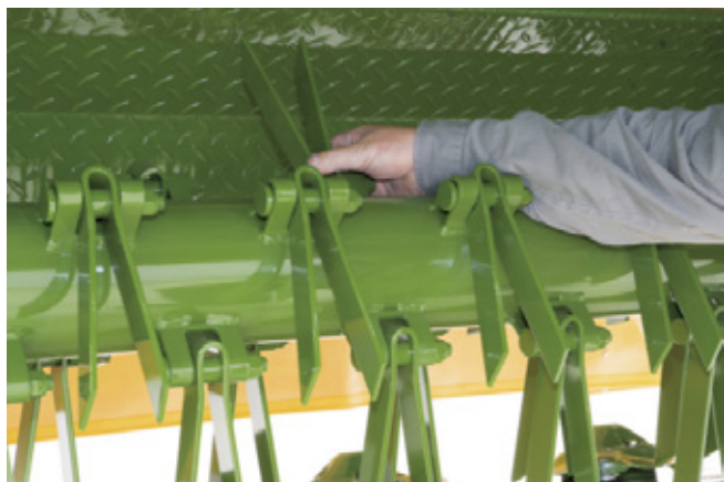
Ütőujjas szársértő típusok rotációs kaszákon (fűfélék kaszálásához).
