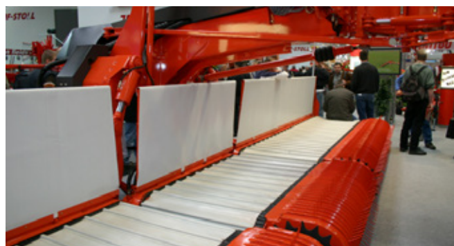
Szállítószalagos rendképző berendezések (Hannover, 2005. és 2015.)
