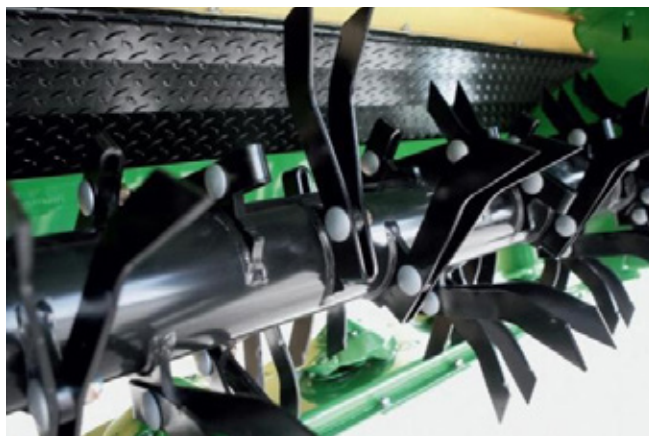
Ütőujjas szársértő típusok rotációs kaszákon (fűfélék kaszálásához).
