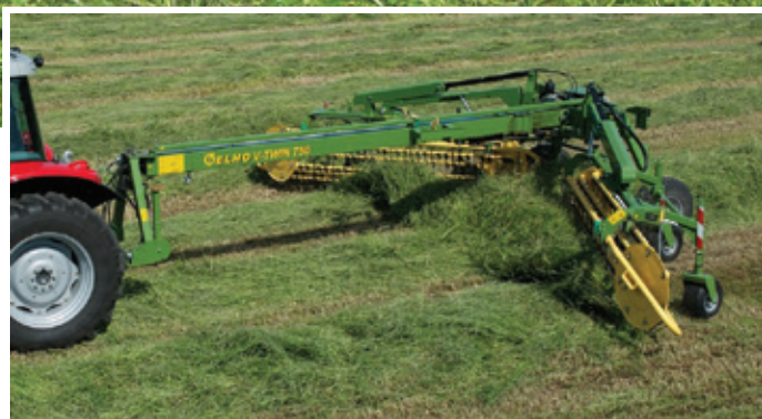
A vontatott kivitelű gépek – V-Twin750; V-Twin950 – munkaszélessége akár menet közben is fokozatmentesen állítható.
