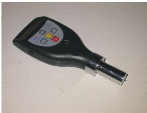
2. kép: SA-HDD típusú műanyag keménységmérő műszer
