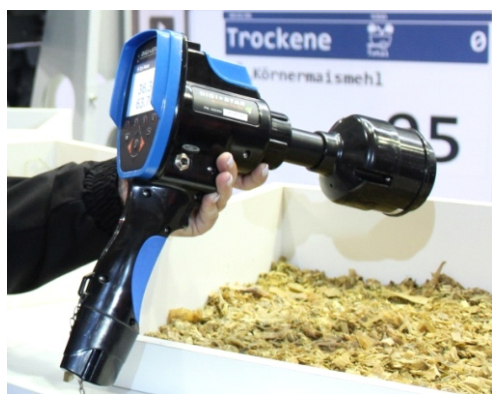
Egy érdekes és nagyon várt új KÉZI műszer: szárazanyag-mérés digitálisan 'on farm- in time' szilázsban, szenázsban, szénában. 20 ponton mérve 1% pontossággal!
