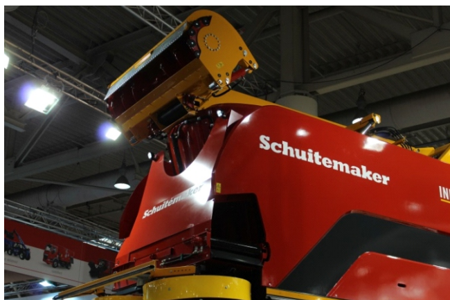
...és a nagy újdonság: számítógéppel vezérelt, silómarós automata etetőkocsi bel- és kültéri munkafeladatokkal, flexibilis útvonallal...
