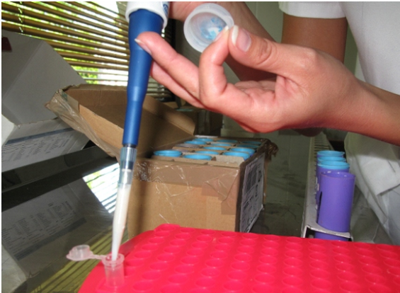
2. ábra: A tejminta kivétele centrifugacsőbe
