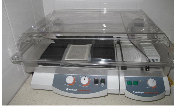
3. ábra: A mintákat tartalmazó mikrotiter lemez a rázóinkubátorban.
