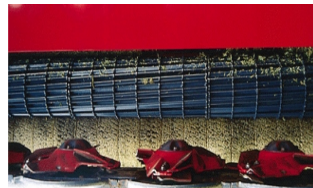
3. kép Speciális szársértővel szerelt tárcsás rotációs kasza (forrás: Jones, 2000)
