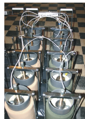
6. kép Hőmérsékletmérés aerob stabilitás vizsgálatakor
