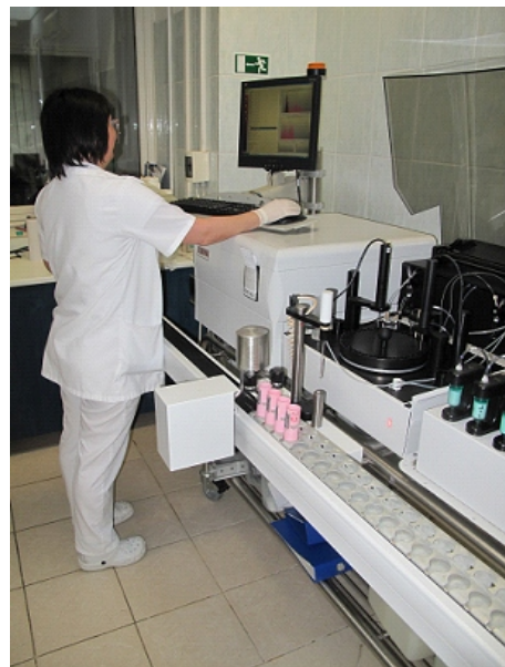
A CFU mérések a Bentley gyártmányú IBC műszeren történnek.
