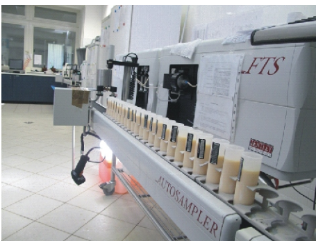
1.kép IR műszeren történő minta analízis
