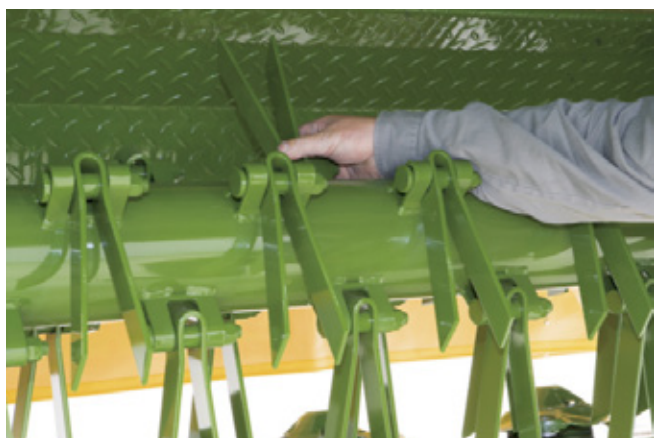
Ütőujjas szársértő típusok rotációs kaszákon (fűfélék kaszálásához).
