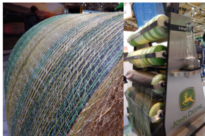
A B-wrap technológiának a lényege, hogy a háló alatt található lélegző fólia belülről áttereszti a vízgőzt és a levegőt, de kívülről lepergeti a vizet a báláról
