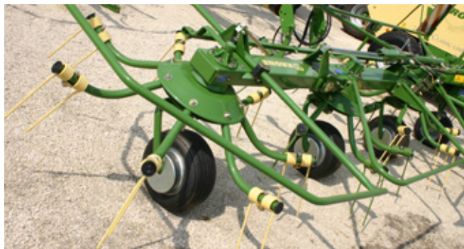
Rendterítő merev ujjakkal: szőnyegrend képzése
