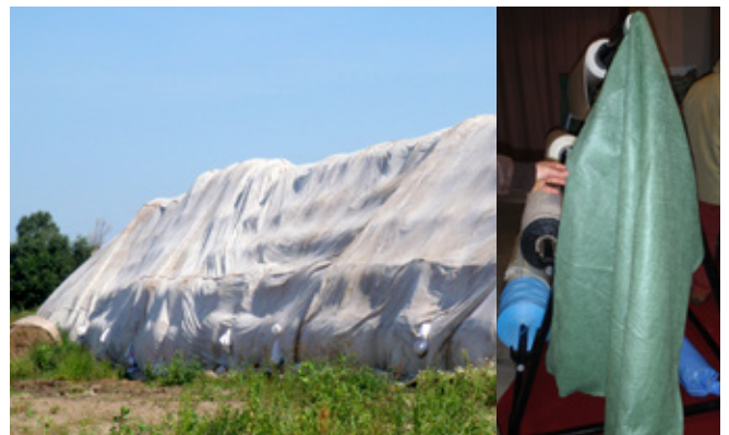
Lélegző-vízlepergető nemez-struktúrájú fedés, és az anyag struktúrája
