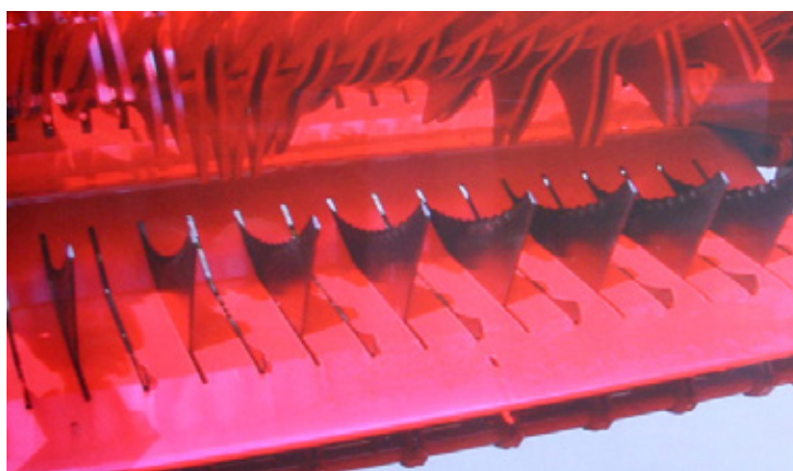
Bálázón található kések: a kések száma határozza meg a szeletméretet
