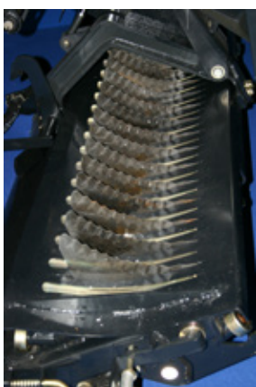
Bálázón található kések: a kések száma határozza meg a szeletméretet
