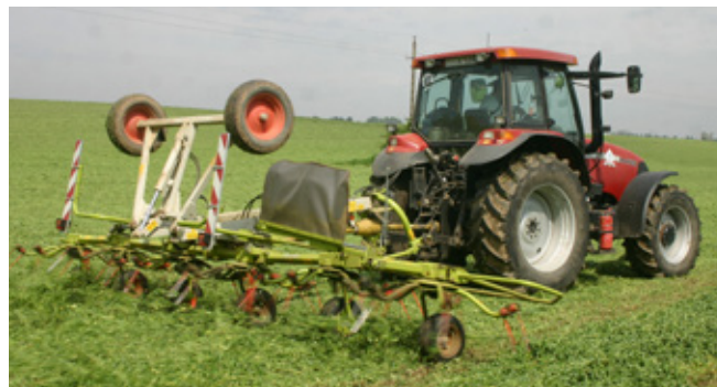
Rendterítő merev ujjakkal: szőnyegrend képzése
