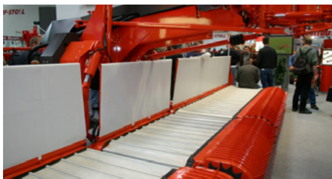
Szállítószalagos rendképző berendezések (Hannover, 2005. és 2015.)
