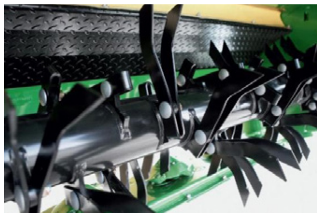
Ütőujjas szársértő típusok rotációs kaszákon (fűfélék kaszálásához).
