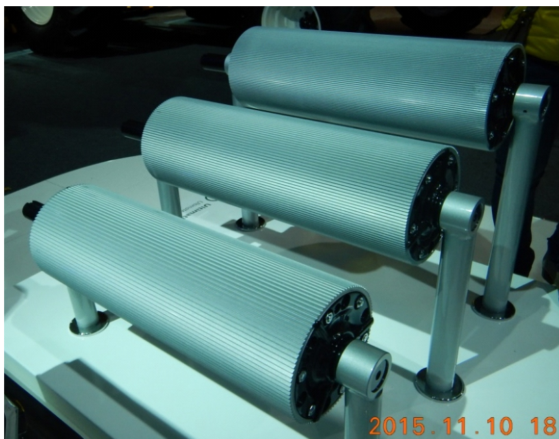
Kép: Hagyományos szemroppantó hengerek különböző átmérővel és fogszámmal (Hannover, 2015. november 10. kép: Orosz Sz.)
