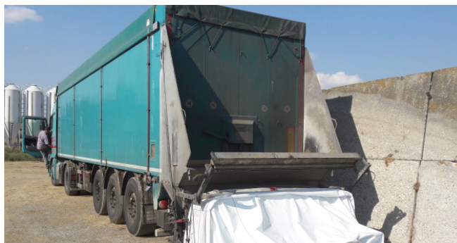
A sörtörköly betöltése horizontális töltéssel, préseléssel. Hosszú távú tárolás.
