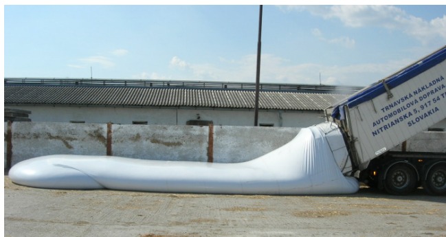
Sörtörköly vertikális, gravitációs töltése rövid távú tárolás esetében, p \leq 0,05 .
