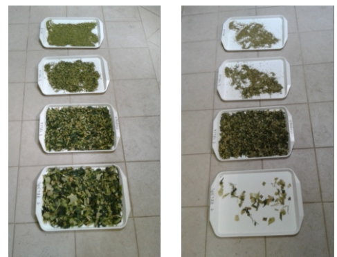
A shredlage (bal, 26 mm) és a normál kukoricazúalék (jobb, 14 mm) között jelentős különbség mérhető a Penn State frakciókban (fotó: Orosz Szilvia, 2016.08.17.)
