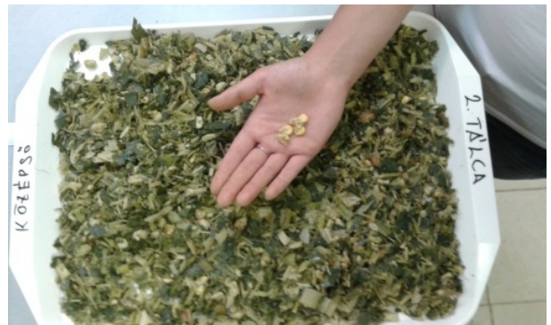
A Penn State rázóládá második szitáján fennmaradó anyag 8-19 mm közötti tartományában talált tört szemek. Az elfogadható és a nagyon jó minőség között szemmel kevés a különbség, itt már mérni kell!
