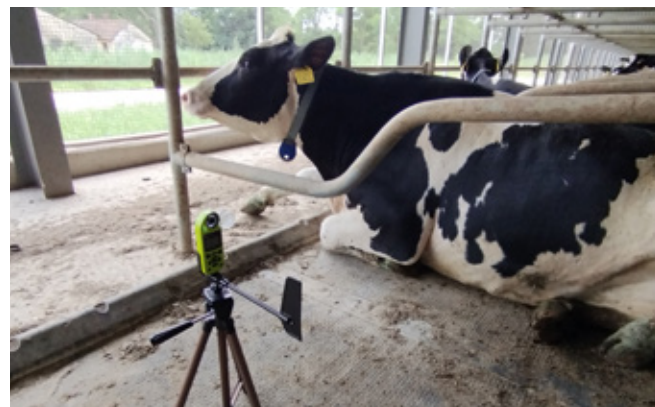
A fekvő tehén magasságában a 2 m/s légssebességet a Kestrel mérőeszközzel ellenőrizzük Turán (fotó: Orosz, 2024)
