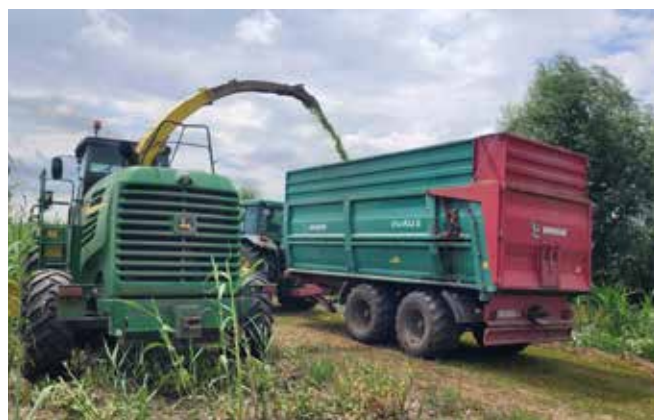
Az Arundo egymenetes betakarítása John Deere járvaszecskázóval, sorfüggetlen adapterrel Szarvason (2023.07.24., kép: Sárréti Dániel, 2023.07.24.)
