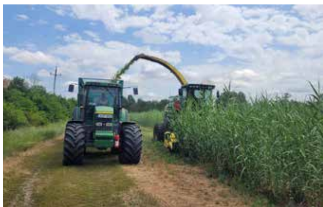
Az Arundo egymenetes betakarítása John Deere járvaszecskázóval, sorfüggetlen adapterrel Szarvason (2023.07.24., kép: Sárréti Dániel, 2023.07.24.)
