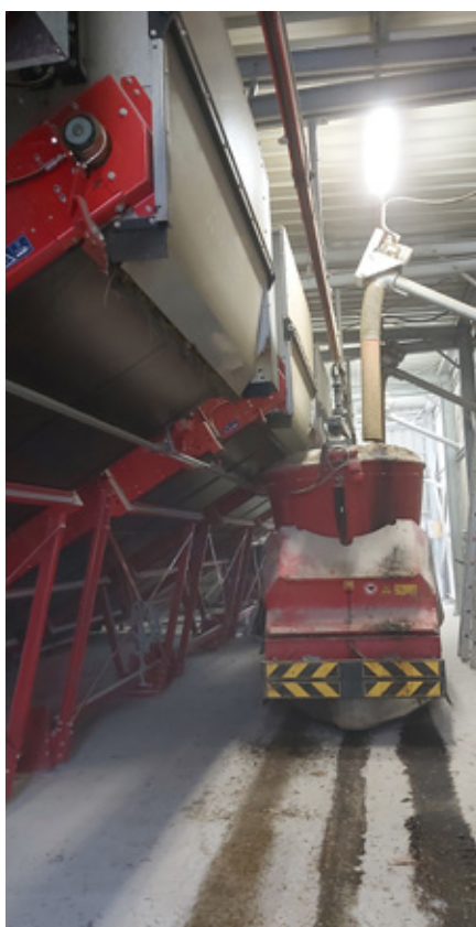
Trioliet rendszer: 5 db, egyenként 18 m 3 -es kaparóléces előtároló konténer az etetőkonyhában és az etetőrobot 2021. április 3-án (fotó: Orosz) Az etetőrobot 6-szori etetése hatékonyan stimulálja a teheneket az evésre (fotó: Orosz, 2021. április 3.)
