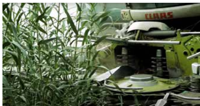
1. képsor: Claas Jaguar járvaszecskázó sorfüggetlen kukoricaadapterrel
