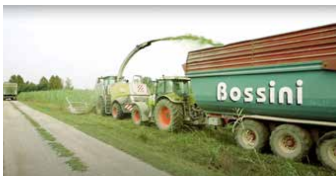
1. képsor: Claas Jaguar járvaszecskázó sorfüggetlen kukoricaadapterrel
