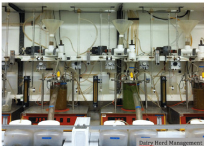
1. ábra: Czerkawski RUSITEC-berendezése
