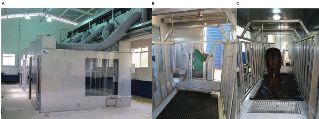
1. kép: Egy klimatizált légzőkamra A. külső kialakítása; B. belső tere takarmány- és víztartályokkal, illetve C. ráccsal a trágya és a vizelet számára Forrás: Machado és mtsai. (2006).
