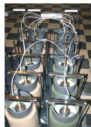
6. kép Hőmérsékletmérés aerob stabilitás vizsgálatokor
