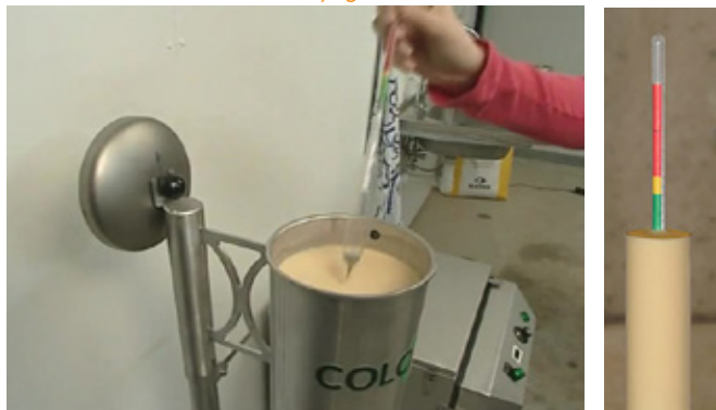
1-2. ábra: A kolosztrom ellenanyagainak mérése kolosztrométerrel
